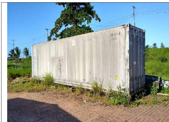
Container refrigerado para armazenamento de camarão
